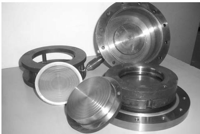
Рис. 6. Общий вид комплекта деталей вакуумированной камеры, пресс-матрицы для штамповки и образца СДЛ
