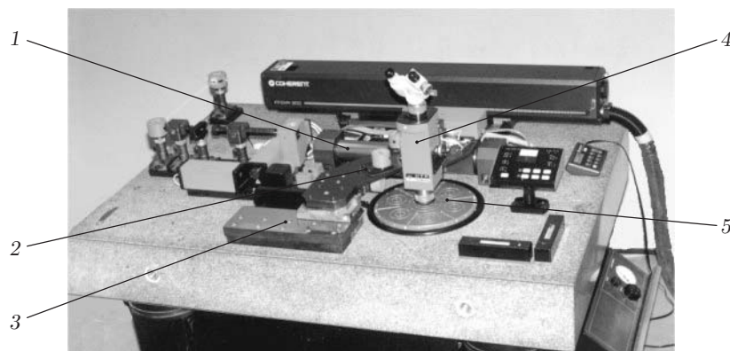
Рис. 1. Общий вид лазерного генератора изображений CLWS-300: 1 — круглая направляющая, 2 — портал, 3 — плоская направляющая, 4 — головка записи, 5 — шпиндельный узел
