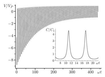
Puc.~5. Переходный процесс установления равновесного режима генератора тока при  $\alpha'=0.11,~\omega RC_1S=1.11\cdot 10^2~(Q_P=10^{-3}~{\rm K}\pi/{\rm m}^2,~\varepsilon=10,~d=1~{\rm mkm},~d_{10}=1~{\rm mkm},~d_{1\,{\rm min}}=10~{\rm mm},~S=1~{\rm mm}^2,~R=20~{\rm \Gamma Om},~f=100~{\rm \Gamma II})$
