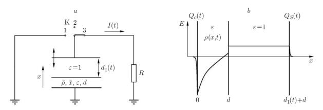
$Puc.\ 1.$  Схематическое изображение генерации электрической энергии на основе диэлектрика со встроенным зарядом: принципиальная схема электростатического генератора (a); распределение поля в некоторый момент времени t в структуре металл—диэлектрик со встроенным зарядом—воздушный зазор—вибрирующий электрод (b)
