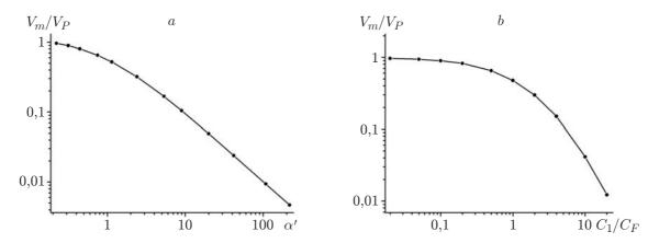
*Puc. 8.* Зависимость амплитуды выходного напряжения токового генератора от безразмерных параметров модели:  $a - \alpha'$ ,  $b - C_1/C_F$  ( $\alpha = 0.02$ );  $RC_1S\omega = 1.11 \cdot 10^{-2}$
