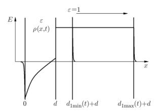
Puc. 2. Схема распределения поля в структуре металл—диэлектрик со встроенным зарядом—воздушный зазор—подвижный электрод в фазе раздвижения пластин в условиях разомкнутой цепи
