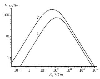
Puc.~9.~ Нагрузочные характеристики токового генератора площадью  $S=1~{
