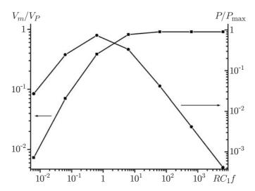
Puc. 7. Частотно-нагрузочные зависимости развиваемой мощности и выходного напряжения для токового генератора при  $\alpha'=0.1$
