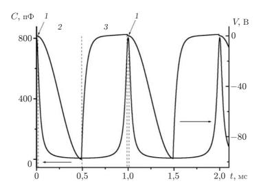
Puc. 4. Поведение C(t) и V(t) в генераторе напряжения на основе сегнетоэлектрика с  $\varepsilon=1000$  и поляризацией  $Q_P=10^{-2}~{\rm K}{\rm n/m}^2$ . Остальные параметры, как на рис. 3
