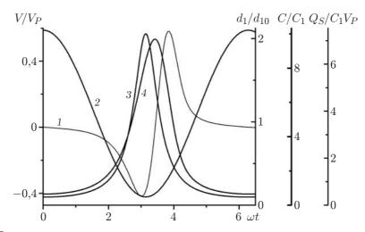
Рис. 6. Пример численного решения уравнения, описывающего работу генератора тока в установившемся режиме при синусоидальном изменении величины зазора  $d_1$ : кривая  $1-V/V_P$ ,  $2-d_1/d_{10}$ ,  $3-C/C_1$ ,  $4-Q_S/C_1V_P$ ;  $\alpha'=0,1$ ;  $\omega RC_1S=6.25\cdot 10^{-4}$
