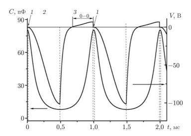
Puc.~3.~ Поведение C(t) и V(t) в генераторе напряжения при  $Q_P=10^{-3}~{\rm K}{\rm fl/m}^2,$   $\varepsilon=10,~d=1$  мкм,  $d_{10}=0.5$  мкм,  $d_{1\min}=10$  нм, S=1 мм $^2,~R=10$  МОм
