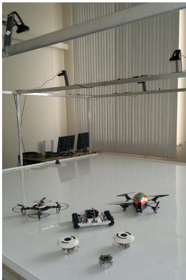
Стенд для тестирования и отладки систем управления и навигации автономными мобильными платформами
