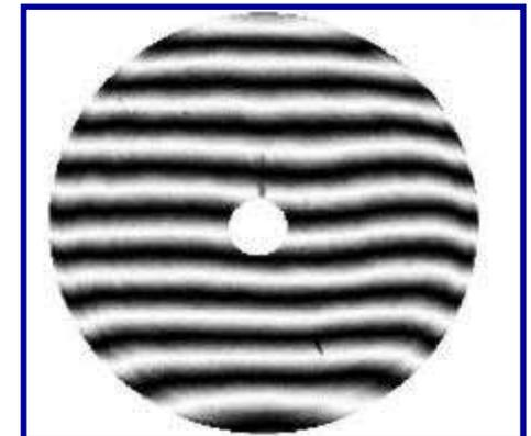
ДОЭ №2. Проверка компенсатора на 633 нм: ошибки  $0.027 \lambda$  rms
