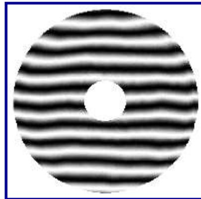
ДОЭ №1. Проверка компенсатора в ИК (10.6 мкм) диапазоне:  $0.02 \lambda$
