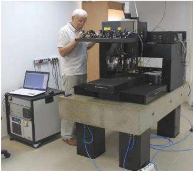
Лазерная трехканальная рабочая станция 3d микрообработки
