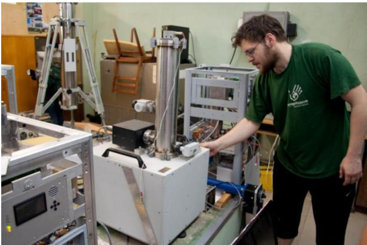
Еще один прибор, который [ИАиЭ](#) представит на Технопроме-2017 – гравиметр. Он предназначен для измерения абсолютной величины ускорения силы тяжести (или ускорения свободного падения, как известно, этот показатель составляет  $9,8 \text{ м/с}^2$ ). Аппарат используют в геодезии, для изучения структуры Земли, поиска полезных ископаемых, в сейсмологии. Кроме того, все запуски космических ракет требуют знания абсолютного
