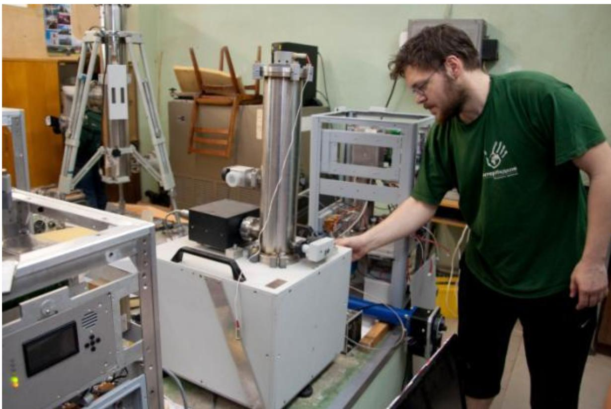
Еще один прибор, который [ИАиЭ](#) представит на Технопроме-2017 – гравиметр. Он предназначен для измерения абсолютной величины ускорения силы тяжести (или ускорения свободного падения, как известно, этот показатель составляет 9,8 м/с). Аппарат используют в геодезии, для изучения структуры Земли, поиска полезных ископаемых, в сейсмологии. Кроме того, все запуски космических ракет требуют знания абсолютного
