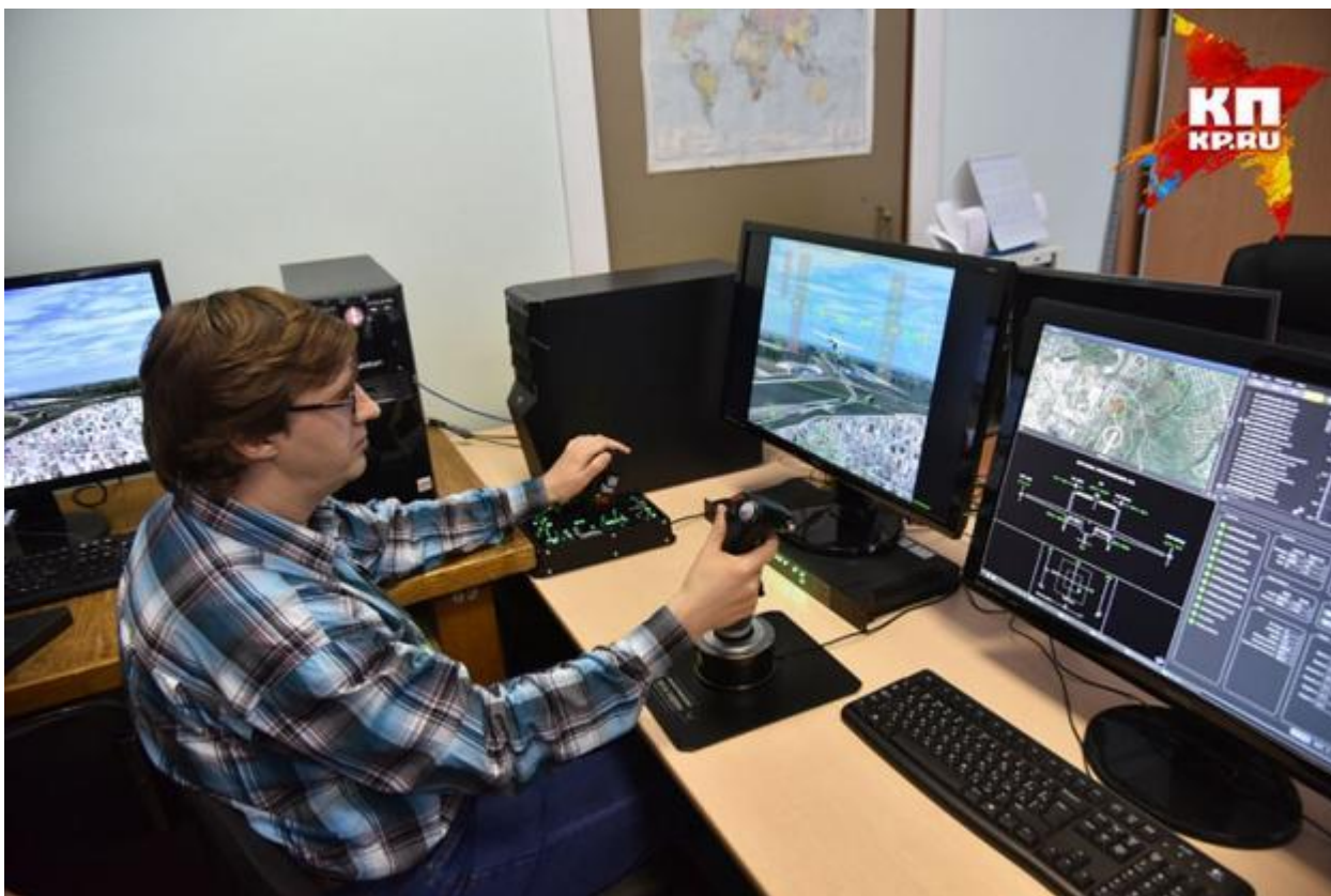
Система тестирования моделей помогает авиаторам испытывать новые самолеты. Фото: ВЛАД КОМЯКОВ.
