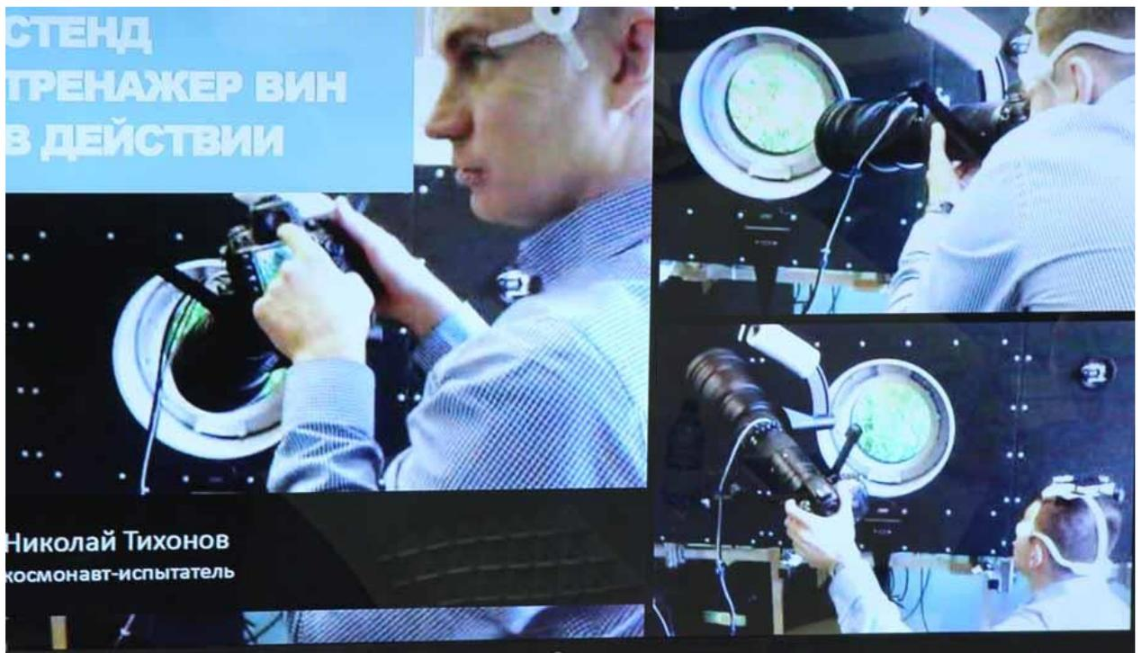
Тренажёр трёхмерной стыковки, в разработке которого учёные СО РАН также принимают участие, позволяет космонавтам отработать навыки стыковки в ручном режиме при отказе автоматики. Практика показывает, что раз в год-два такая потребность у астронавтов возникает.
