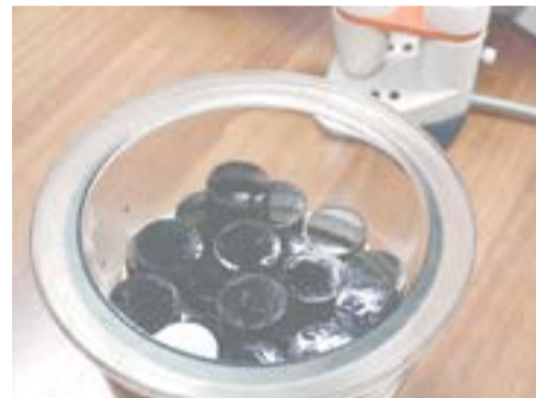
Аншлиф-брикеты — отполированные заготовки из проб измельченного угля
