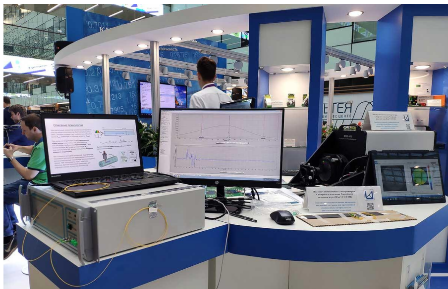
Стенд ИАиЭ СО РАН: слева – система опроса волоконно-оптических датчиков встроенных в композитные материалы, справа – прецизионная цифровая интерферометрическая система для контроля формы оптических поверхностей
