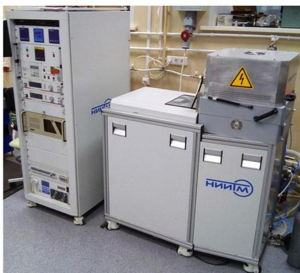
*Лазерная литографическая установка DWL-66+ HiRes (слева) и установка реактивного ионного травления «ПЛАЗМА-200ТМ-1» (справа) в ЦКП «Спектроскопия и оптика»*
