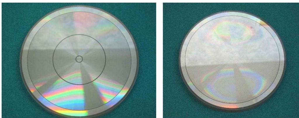
*Фотографии двух голограмм, записанных на ситалловых подложках диаметром 165 мм для проверки телескопа JWST*
