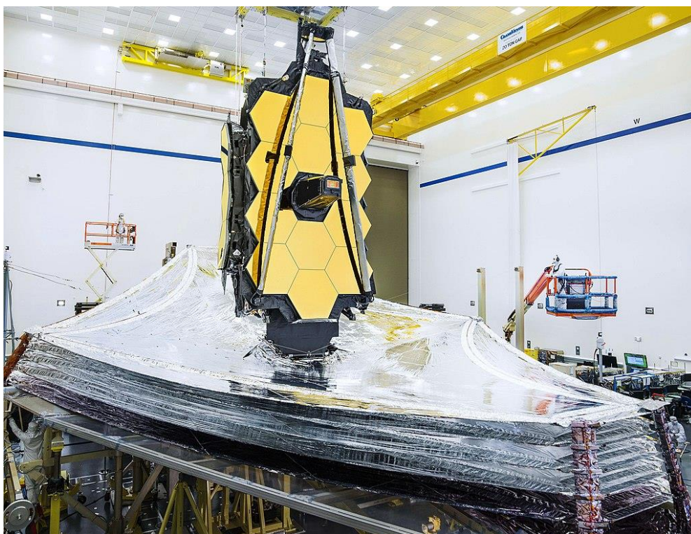
Собранный телескоп Джеймса Уэбба во время тестирования развёртывания теплозащитного экрана, 2019 год
