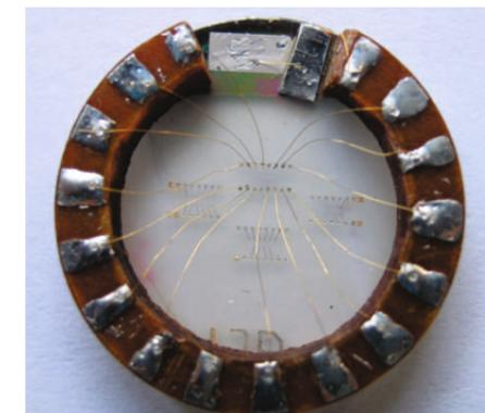
Линейки, 2x8, электрооптических модуляторов света на основе пленок НБС, размер окна 100x100 мкм, шаг - 100 мкм. 1987 г.
