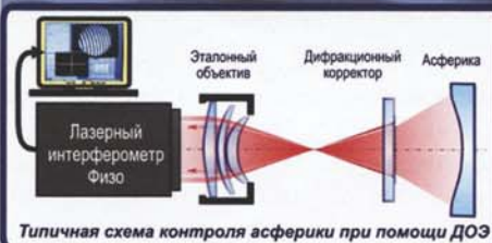
Типичная схема контроля асферики при помощи ДОЭ
