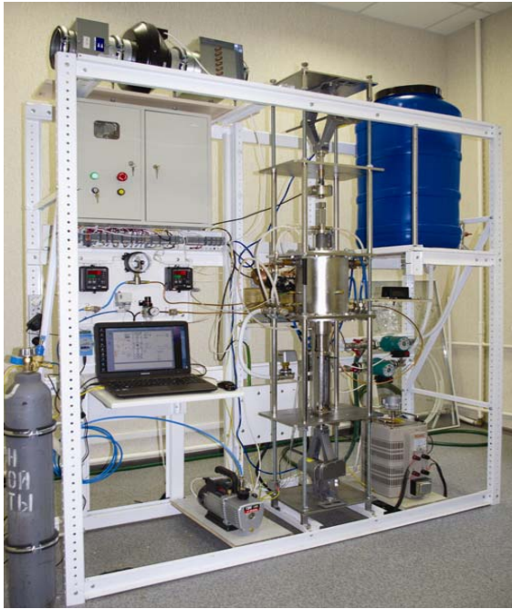
Рис. 1.7. Внешний вид компактного лабораторного горячего пресса
