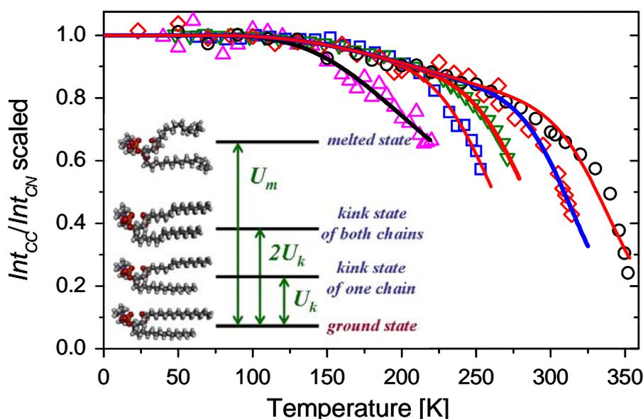
Температурная зависимость сигнала КРС для СС-связи пяти различных фосфолипидных мембран (символы) и их описание моделью (линии). На вставке показаны конформационные состояния фосфолипидной молекулы, рассматриваемые в модели
