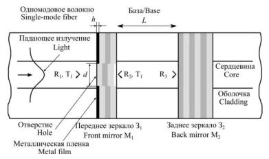
Схема отражательного интерферометра на основе металл-дифракционной структуры. В составе переднего асимметричного по коэффициентам отражения зеркала  $3_1$  ( $0 \approx R_1 << R_2 \sim 1, T_1 > 0, R_3 = 1$ ) использована алюминиевая пленка толщиной h = 30 нм с диаметром отверстия d = 6.7 мкм. Падающее излучение (основная мода волокна) рассеивается
