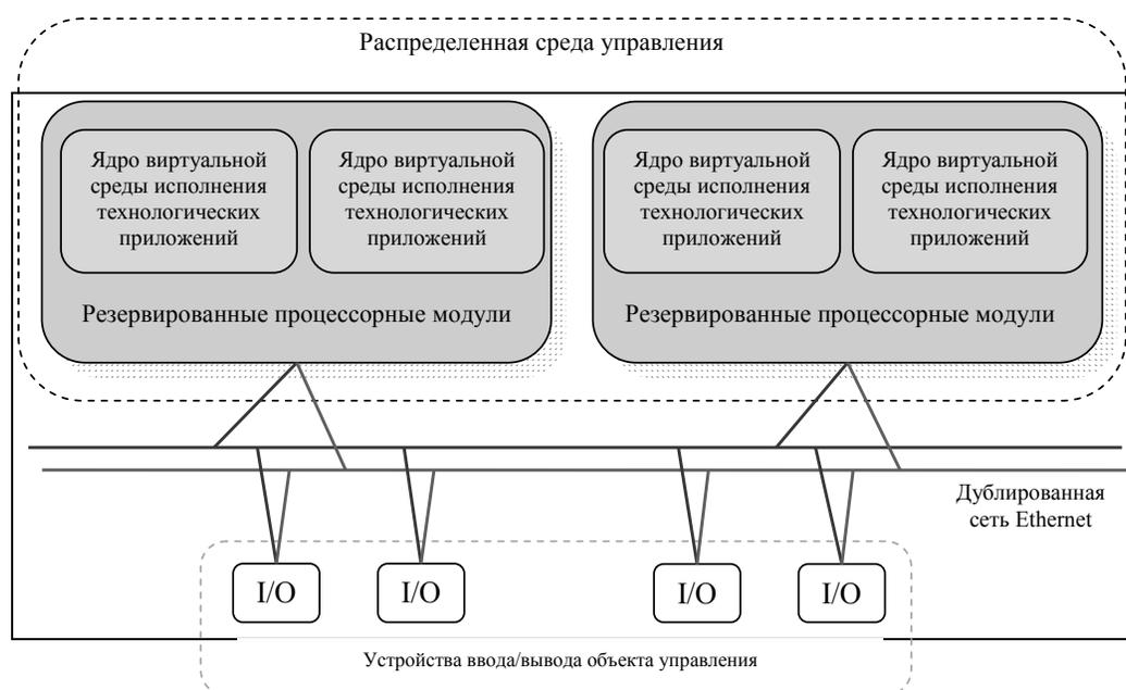
**Рис. 2.36.** Архитектура ПТК, основанная на однородной распределенной среде управления
