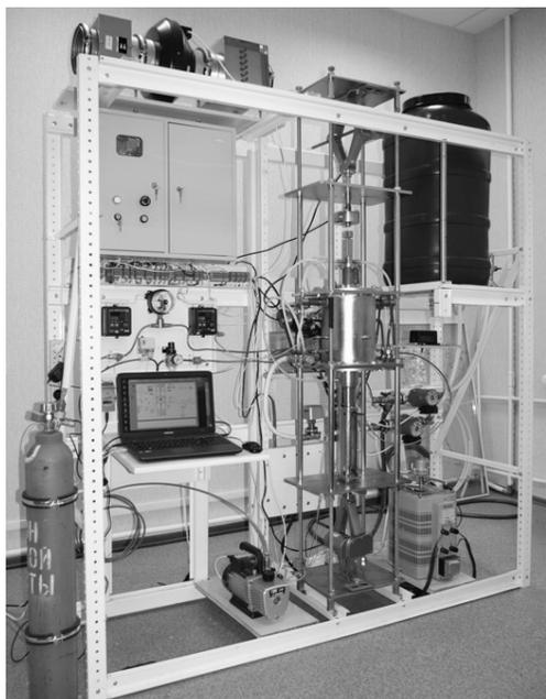
**Рис. 6.4.** Внешний вид исследовательского автоматизированного высокотемпературного прессы
