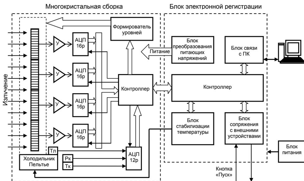
Рис. 2.11. Структурная схема анализатора МАЭС с  $T_{\min} = 1$  мс
