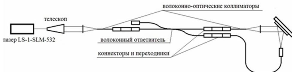
**Рис. 2.11.** Волоконный интерферометр для записи плоских внеосевых голографических зеркал
