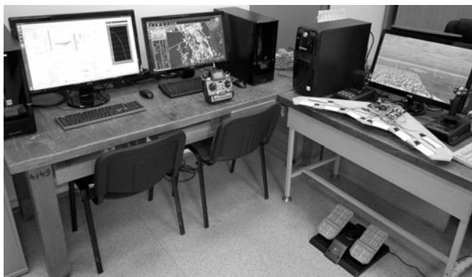
**Рис. 2.52.** Стенд полунатурного моделирования
