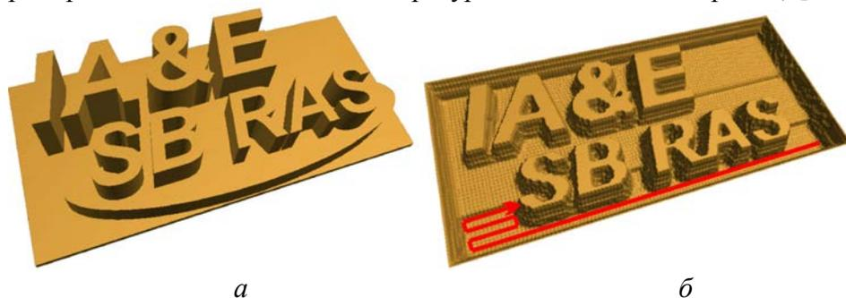
**Рис. 2.24.** *a* – трехмерная модель тест объекта в среде AutoCAD; *б* – результат компьютерного моделирования лазерной обработки стального образца импульсным ИАГ лазером  $\lambda = 1.06$  мкм средняя мощность 100 Вт, длительность импульсов 200 нс по данной модели. Красным выделен фрагмент траектории лазерного луча
