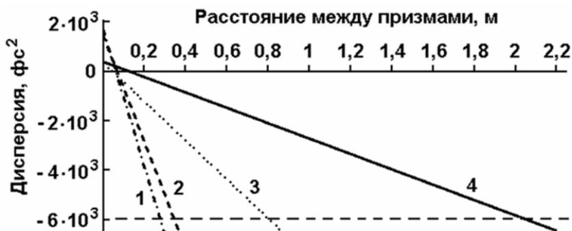
**Рис. 2.20.** Дисперсия призмного компенсатора дисперсии для разного материала призм: 1 – ТФ10, 2 – ТФ5, 3 – сапфир, 4 – плавленый кварц. Горизонтальной штриховой линией показана дисперсия резонатора
