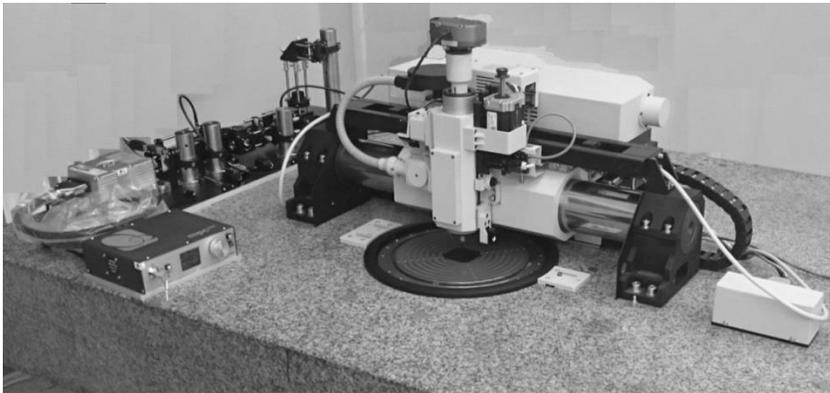
Рис. 4.11. Двухканальная круговая лазерная записывающая система
