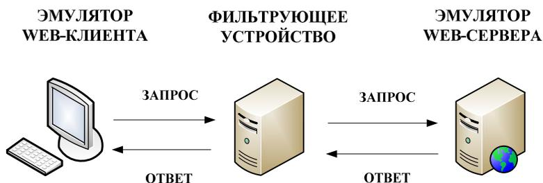
**Рис. 2.52.** Схема стенда для проведения испытаний фильтрующего устройства
