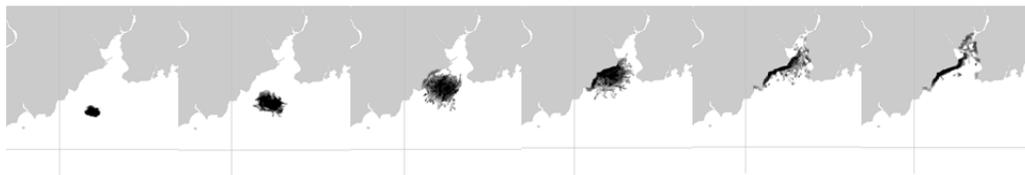
**Рис. 2.50.** Результаты моделирования процесса разлива нефтяного пятна, проведенного с помощью рекуррентной нейронной сети с учетом течения и ветра
