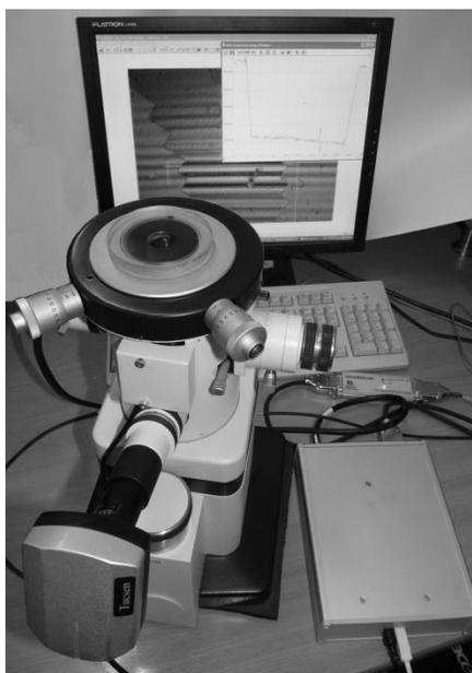
**Рис. 4.13.** Оптический профилометр на базе микроинтерферометра МИИ-4М
