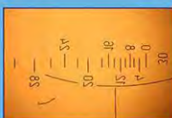
Гравировка стекла (ширина линии 5 мкм) Engraving of glass (the line width is 5 \mu\text{m} )
