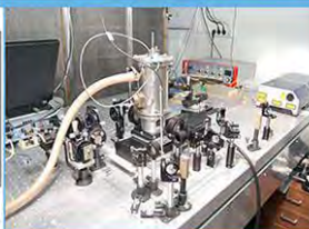
Терагерцовый спектрометр с установленным криостатом Terahertz spectrometer with the cryostat
