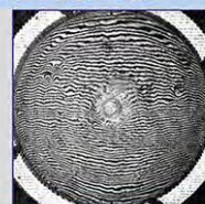
Интерферограмма зеркала БТА Interferogram of BTA mirror
