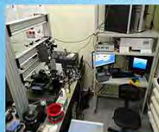
Лабораторный макет установки по записи ВБР с помощью фемтосекундного волоконного лазера
