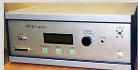
Волоконный РОС-лазер 1 Вт @ 1030 нм DFB fiber laser 1 W @ 1030 nm
