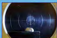
Гравировка стекла (ширина линии 5 мкм) Engraving of glass (the line width is 5 \mu\text{m} )
