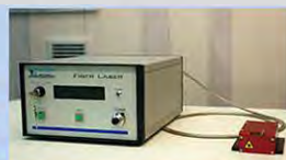
Волоконный поляризованный лазер 5 Вт @ 1064 нм Linearly polarized fiber laser 5W @ 1064 nm
