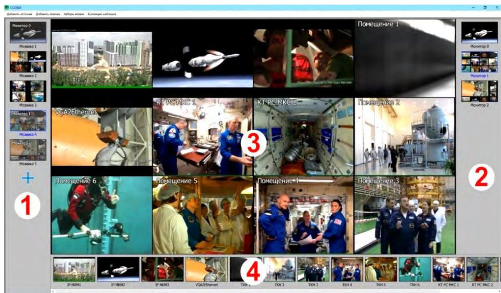
Рис. 2.40. Графический пользовательский интерфейс для формирования «мозаик» входных видеосигналов: 1 – панель миниатюр «мозаик» с заранее заданной конфигурацией; 2 – панель миниатюр мониторов удаленных пользователей; 3 – центральная панель, содержащая окна предварительного просмотра выходных данных; 4 – панель выбора источников данных
