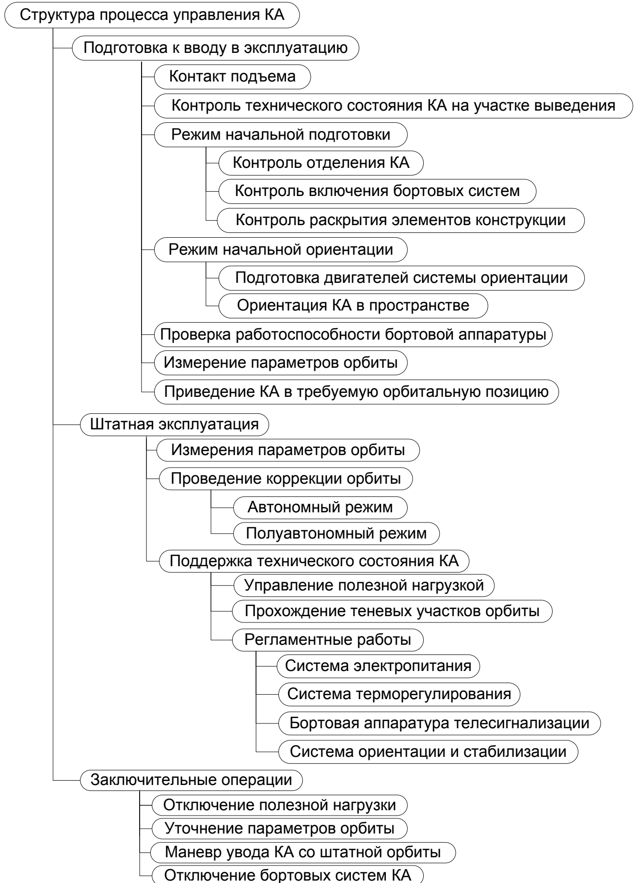
Рисунок 1 – Структура процесса управления КА
