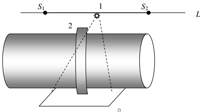
*Схема сбора проекционных данных на примере установки, предназначенной для инспекции трубопроводов, находящихся в эксплуатации. 1 – источник рентгеновского излучения; 2 – исследуемый объект (шов, соединяющий участки трубопровода); D – детектор; L – прямая, вдоль которой движется источник;  $S_1$  и  $S_2$  – точки, ограничивающие траекторию источника*
