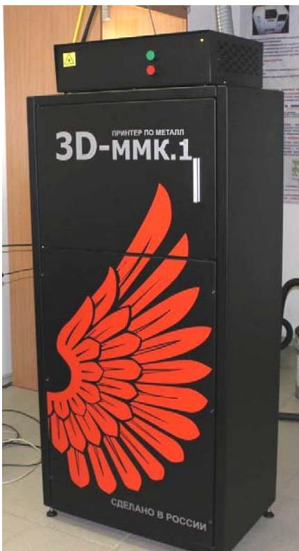
*Лазерная система для аддитивного изготовления металлических моделей методом селективного лазерного сплавления мелкодисперсных металлических порошков*
