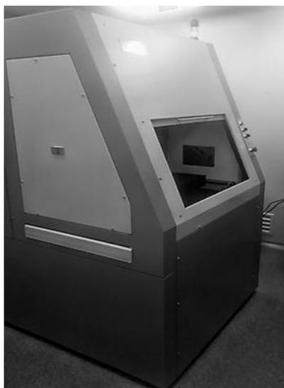
Лазерная технологическая рабочая станция на основе фемтосекундного лазера (ЛРС-Ф) предназначена для микрообработки изделий из металла, керамики, кристаллических материалов и оптического стекла путем трехмерной послойной обработки поверхности, резки и регулируемой объемной оптической модификации прозрачных материалов. ЛРС-Ф обеспечивает высокую точность и разрешение, возможность обработки хрупких материалов без микротрещин и сколов методами прямой лазерной обработки
