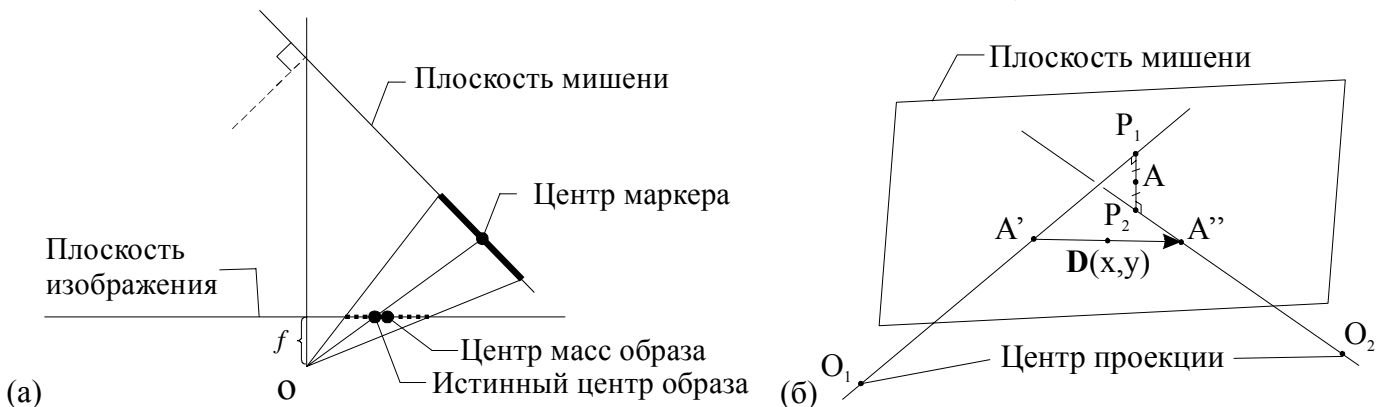
Рис. 6 Схема возникновения ошибки определения центра круглого маркера (а), использование диспаратета \mathbf{D}(x, y) при коррекции калибровки методом триангуляции (б)
