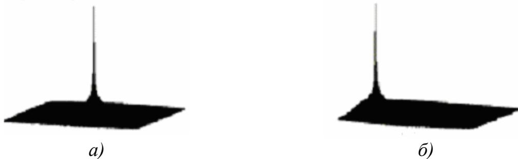
Рисунок 23 – Круговой синтез апертуры: *а*) функция рассеяния центральной точки; *б*) функция рассеяния точки, удаленной от центра на  $14\lambda$
