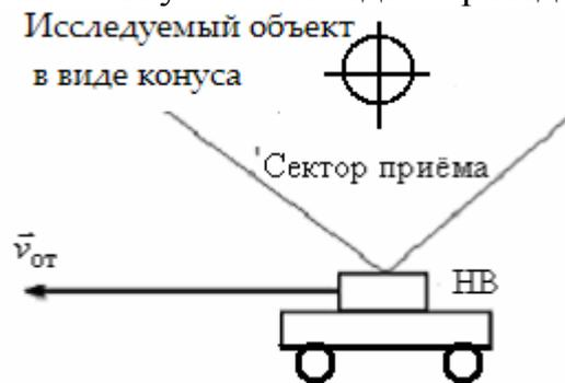
Рисунок 21 – Схема проезда локатора мимо исследуемого объекта
