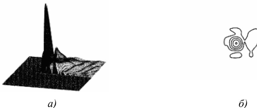
Рисунок 5.44 – Результат эксперимента по синтезу апертуры антенны в двух взаимно перпендикулярных направлениях: *а)* передающая функция шарика; *б)* сечения этой функции плоскостями разной высоты
