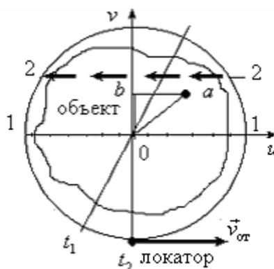
Рисунок 3.29 – Линии одинаковых поперечных скоростей при перемещении локатора по кругу. Прямая 1–1 – линия нулевых скоростей
