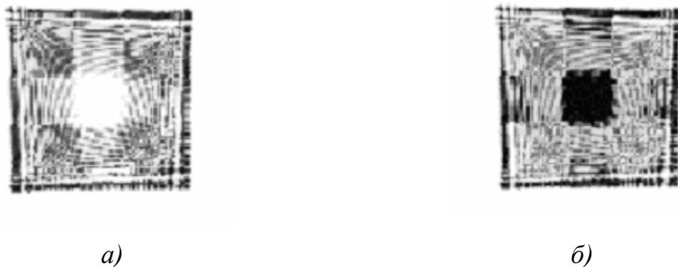
Рисунок 4.5 – Томограммы гомогенной области с включенной неоднородностью: *а*) неоднородность в виде пустоты; *б*) неоднородность в виде гомогенной области с большими модулями комплексной амплитуды рассеяния точек
