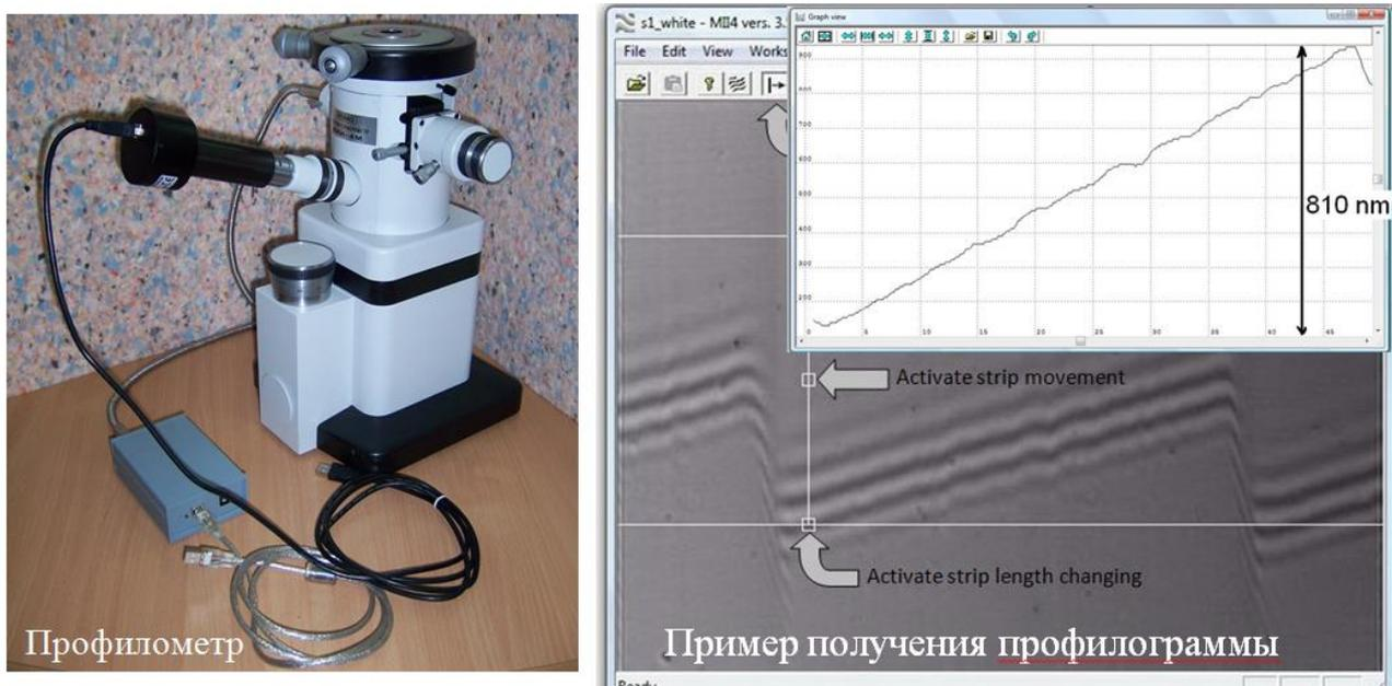
Рис.4. 5. Автоматизированный профилометр на базе МИИ-4 и скриншот его программного обеспечения.
