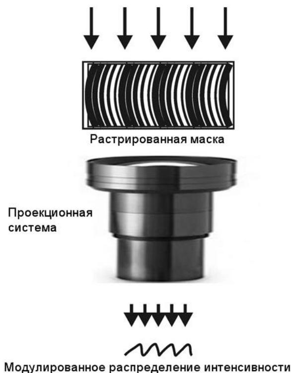
Рис. 3.17. Схема полутоновой литографии с растрированным фотошаблоном.
