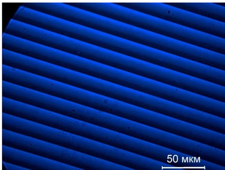
Рис. 2. 12. Фотография фрагмента полутонного фотошаблона, записанного на пленке a-Si магнетронного напыления, снятая в синем свете.
