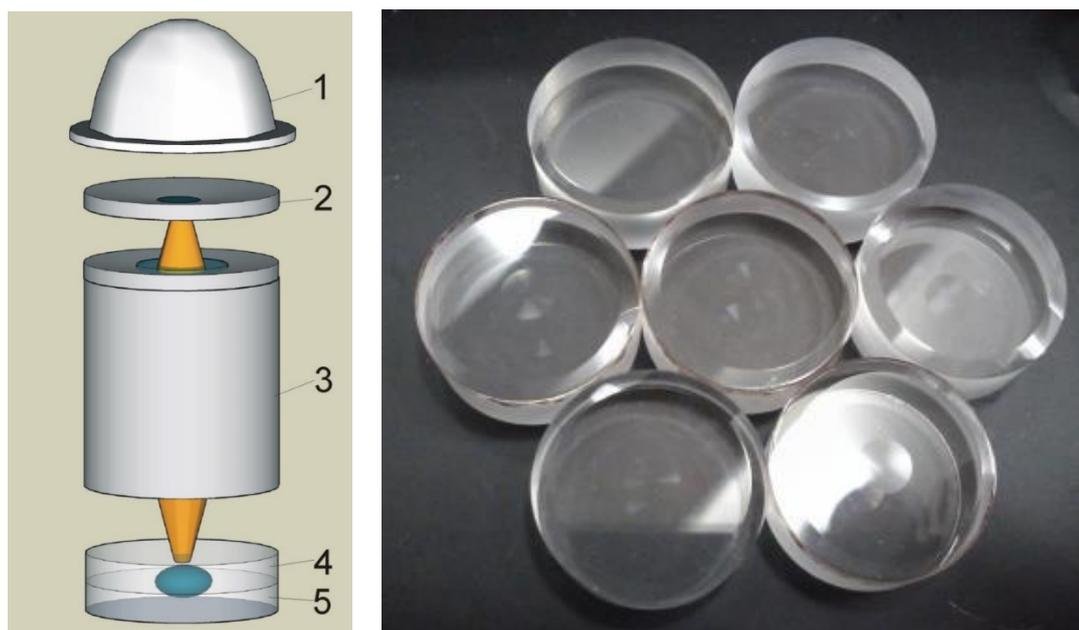
Рис. 5.10. а - Установка для метода фронтальной полимеризации. 1 – осветитель, 2 – управляемая диафрагма, 3 – проекционная оптическая система, 4 - рефракционная матрица, 5 дифракционная матрицы БДРЛ; б – фотография дифракционных матриц для тиражирования БДРЛ.
