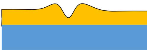
Рис. 1. 11. Схематичное представление типичной формы рельефа на кольце, записанном на фоторезисте.
