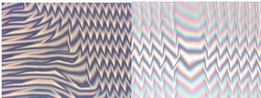
Рис. 5.24. Интерферограммы поверхности дифракционного барельефа.
