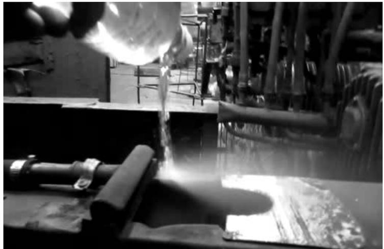
Рис. 11. Настройка подсистемы сверхзвуковой аэродинамической брызгозащиты лазерного комплекса для измерения толщины листового горячего проката
