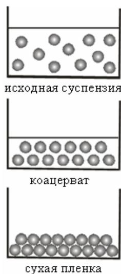
Рис.5. Схема формирования ФК пленки опала методом гравитационной укладки (МГУ) [34]. На начальном этапе формируется коацерват, далее происходит постепенное уплотнение структуры и сушка.
