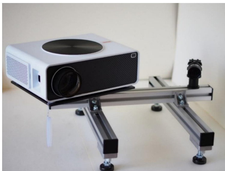
Рис. 6. Адаптивная триангуляционная система для прецизионного контроля параметров массообмена на аэродинамическом стенде ИТ СО РАН.
