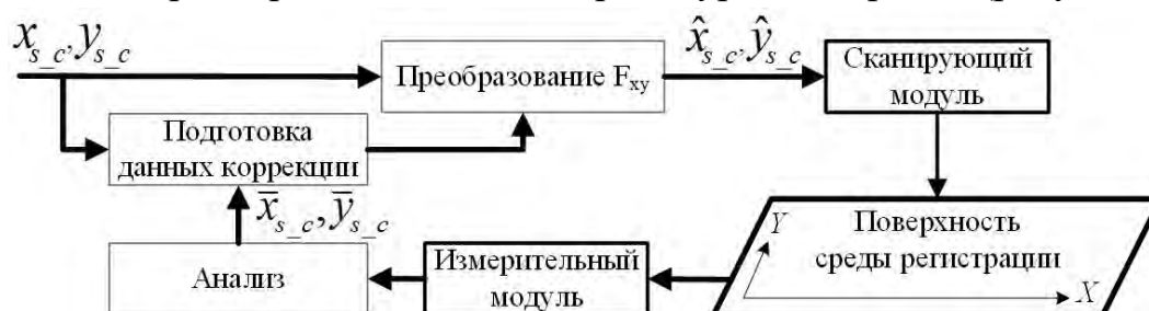
Рисунок 2 Функциональная схема алгоритма калибровки гальванометрического сканирующего модуля
