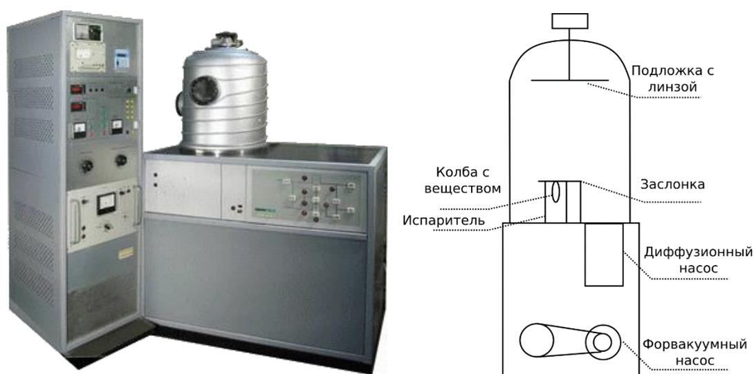
**Рисунок 8. Установка УВН-71-II-3 и ее упрощенная схема**
