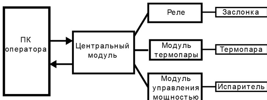
**Рисунок 9. Аппаратная архитектура системы автоматизации установки термовакuumного напыления**
