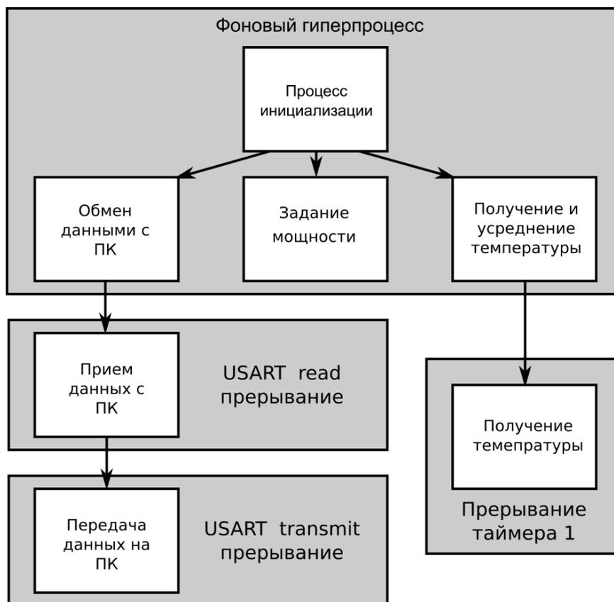
**Рисунок 10. Архитектура ПО микроконтроллера системы автоматизации установки термовакuumного напыления**
