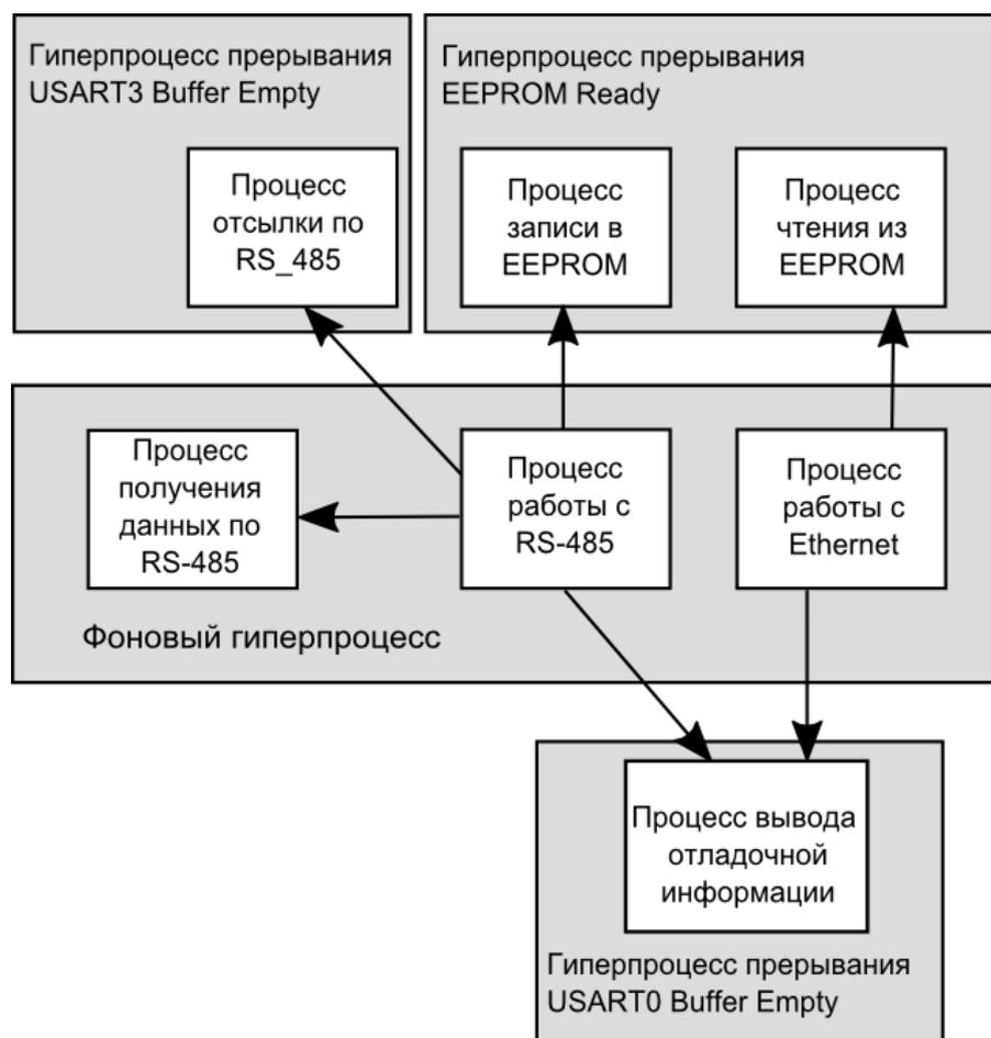
**Рисунок 6. Архитектура ПО метеосервера**
