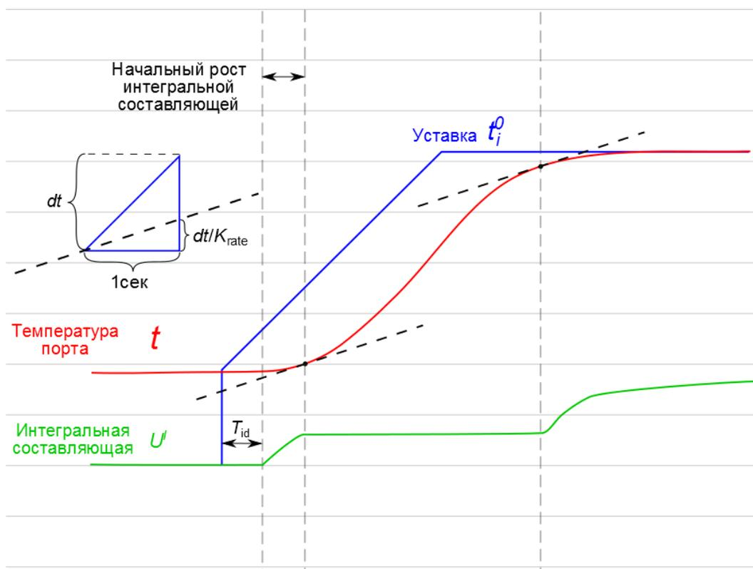
**Рисунок 12. Ограничение интегральной составляющей регулятора температуры в порту дегазации**
