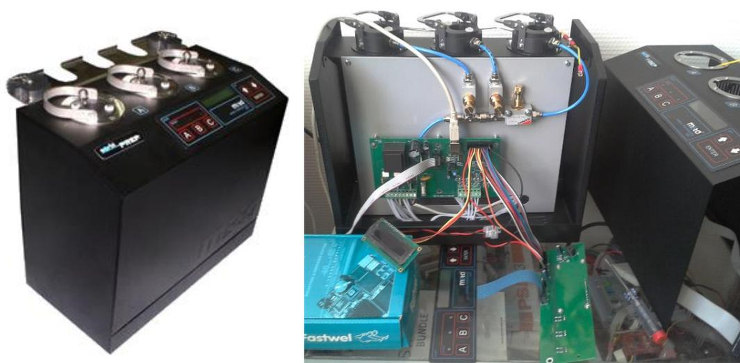
**Рисунок. 11. Станция пробоподготовки SorbiPrep в собранном виде и в процессе отладки программного обеспечения**
