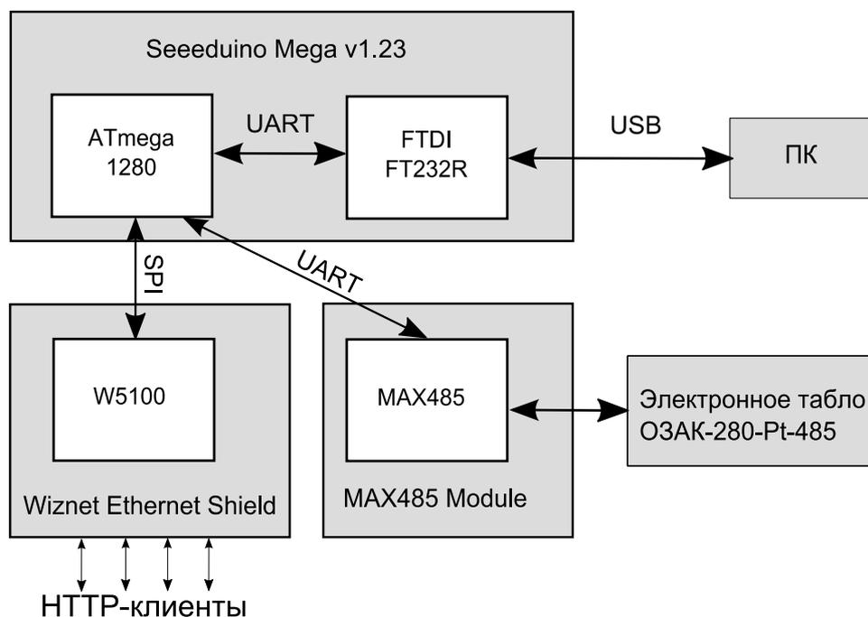
**Рисунок 5. Аппаратная архитектура метеосервера**
