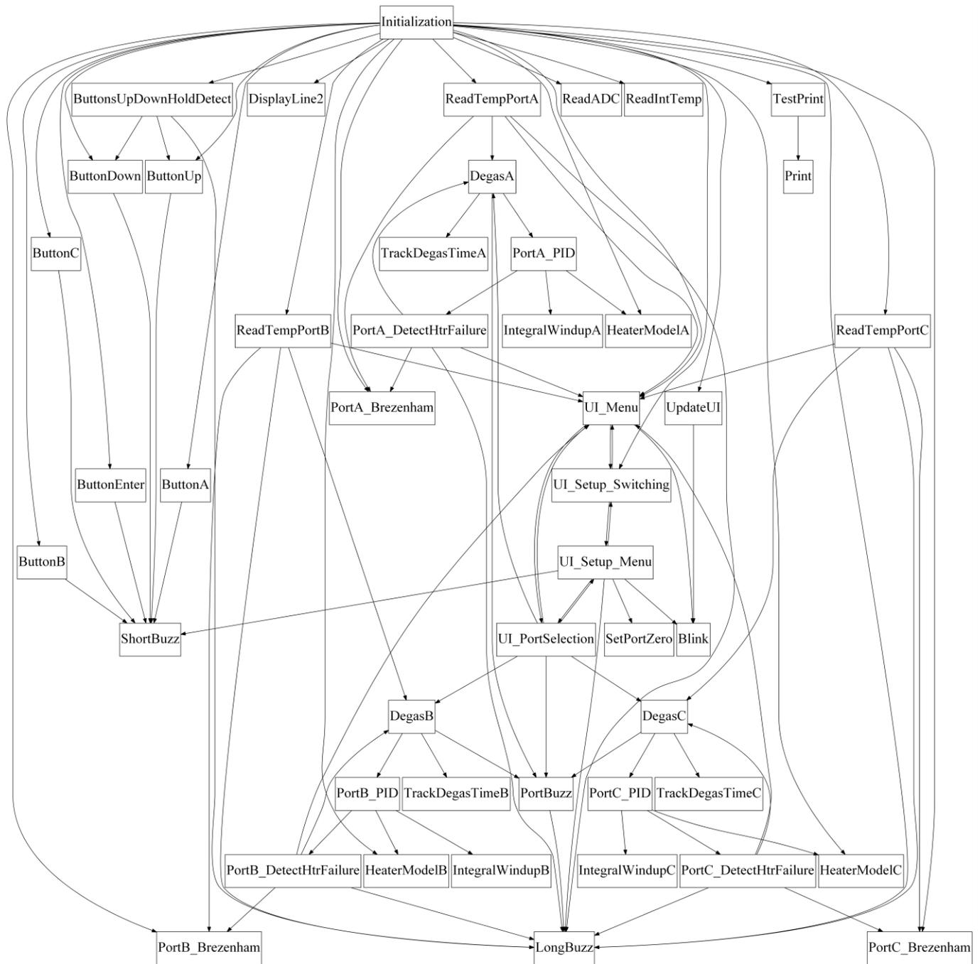
**Рисунок 13. Архитектура ПО станции пробоподготовки SorbiPrep. Стрелками обозначены операции запуска/остановки процессов**
