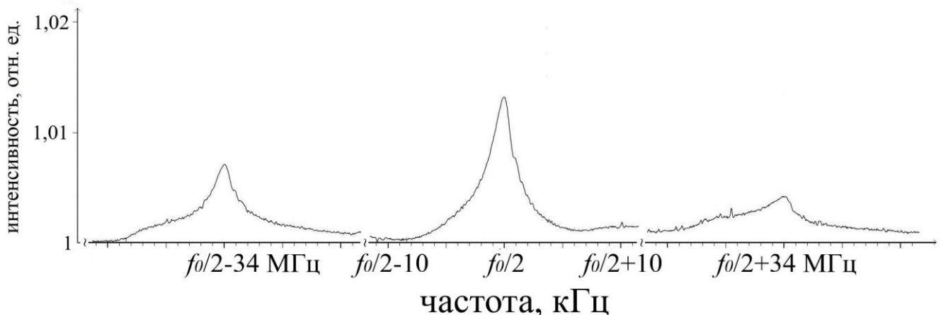
Рисунок 9 – Серия резонансов КПН при совместном действии СВЧ (3,417 ГГц) и ОВЧ модуляции (68 МГц).  $f_0$  – частота часового перехода; сигнал нормирован на значение амплитуды резонанса в отсутствие ОВЧ модуляции.
