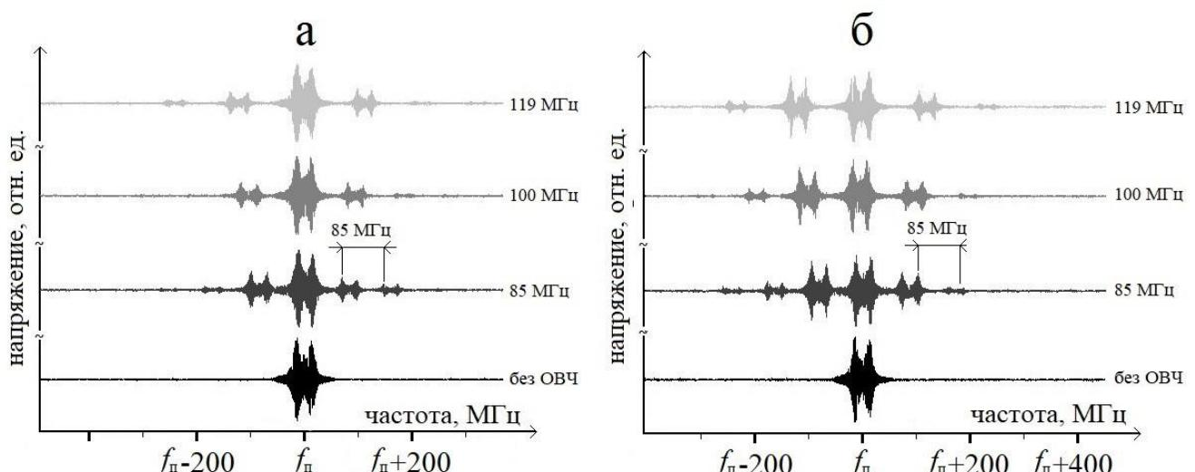
Рисунок 8 – Тонкая структура спектра излучения лазера при СВЧ модуляции частотой 3,4 ГГц и амплитудой 40 мВт (кривая 1) и при совместном действии ОВЧ модуляции амплитудой 0,32 мВт и частотой: 2 – 85 МГц, 3 – 100 МГц, 4 – 119 МГц на НЧ (а) и ВЧ (б) боковых полосах спектра.  $f_n$  – частота полосы.
