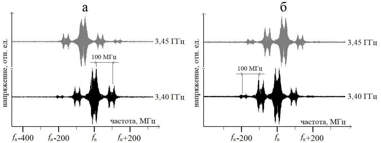
Рисунок 9 – Положение структуры при изменении частоты СВЧ модуляции амплитудой 40 мВт от 3,4 ГГц (кривая 1) к 3,45 ГГц (кривая 2) и совместном действии ВЧ модуляции частотой 100 МГц и амплитудой 0,1 мВт на НЧ (а) и ВЧ (б) боковых полосах спектра.  $f_n$  – частота полосы.
