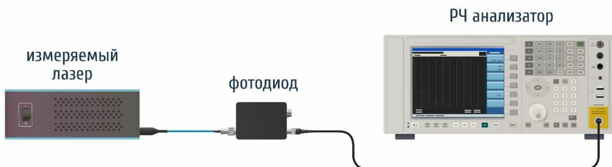
Рисунок 1.16 Схема измерения частотного состава излучения лазера.
