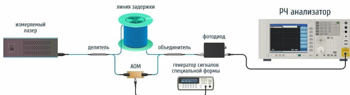
Рисунок 1.24 Схема самогетеродинамирования на основе интерферометра Маха-Цендера.
