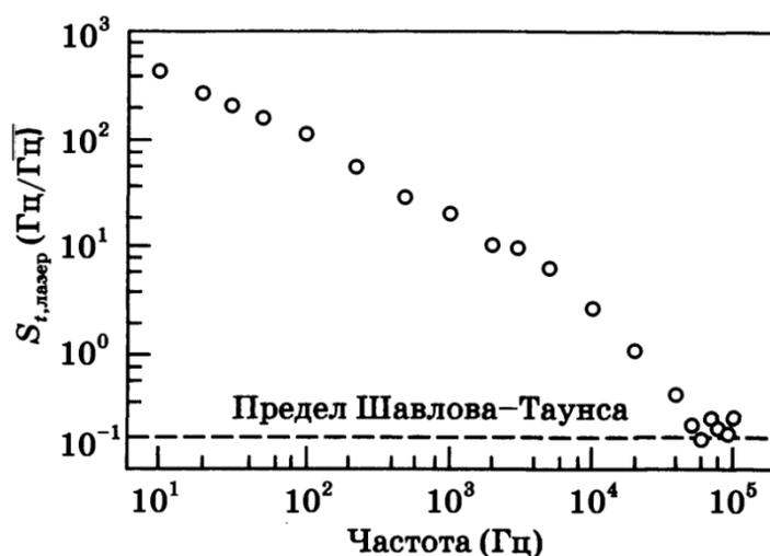
Рисунок 1.23 Спектр частотного шума для Nd:YAG лазера.
