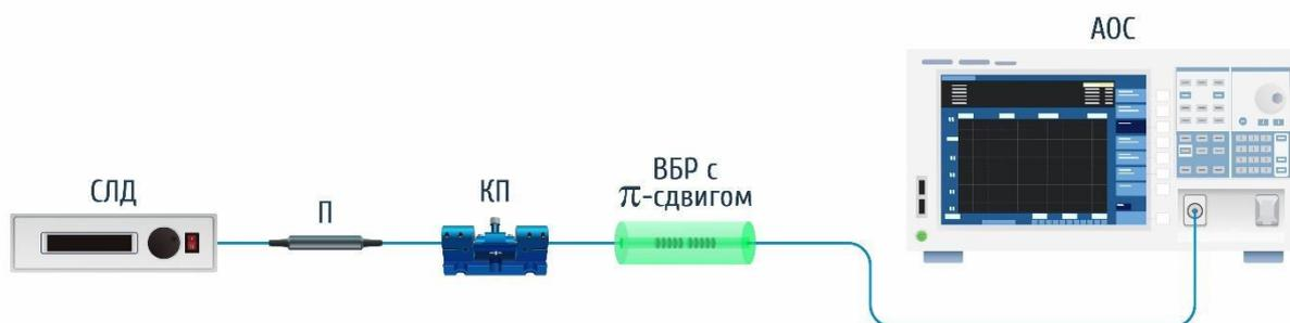
Рисунок 1.15 Схема измерения спектра пропускания  $\pi$ -ВБР.
