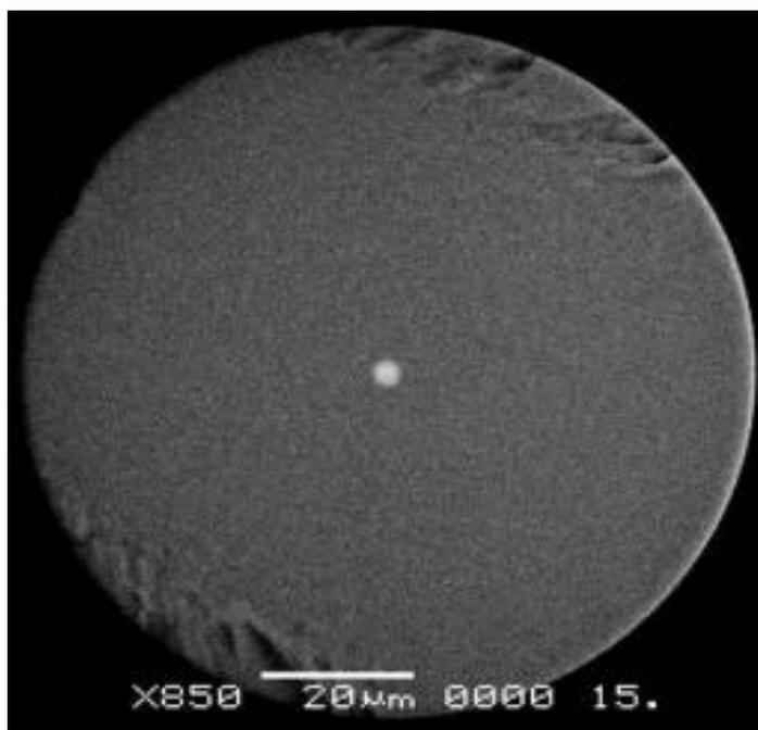
Рисунок 2.9 Изображение торца композитного световода, полученное с помощью электронного микроскопа.
