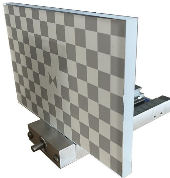
Рис. 3.22. Узел калибровки адаптивных триангуляционных систем прецизионного контроля трехмерной геометрии объектов на аэродинамических и климатических экспериментальных стендах.
