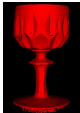
Рис. 1.11. Оптический контроль (а) трехмерной геометрии (г) объектов (б) в среде с флуоресцентным красителем (в).
