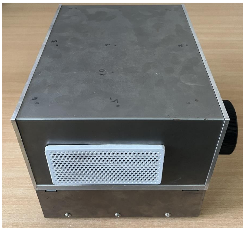
Рис. 3.18. Термостатированный цифровой проектор TouYinGer Q10 с доработанной оптической системой.
