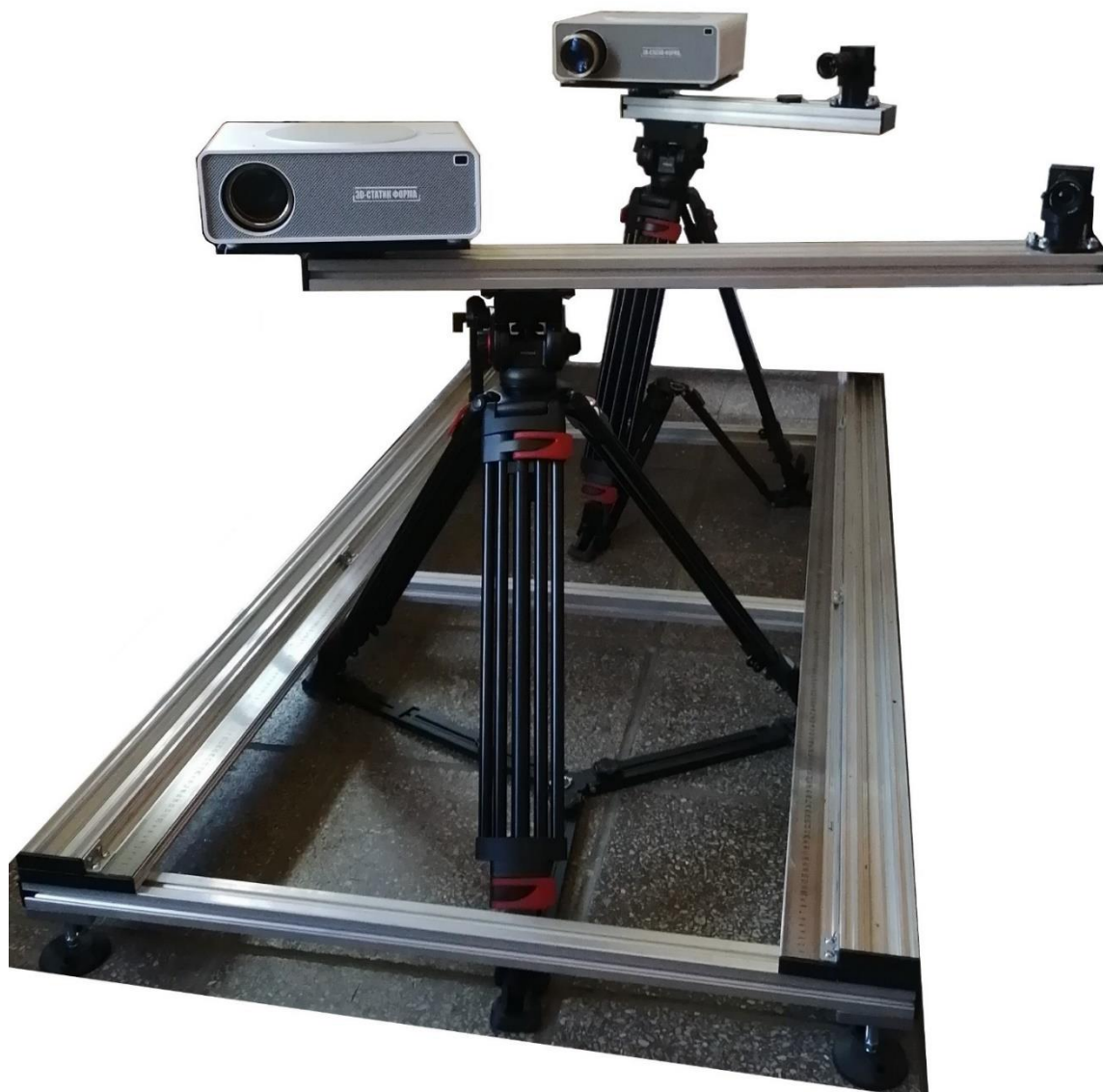
Рис. 3.13. Адаптивная триангуляционная система для контроля деформаций трехмерного профиля объектов в процессе статического нагружения на силовом стенде.
