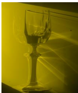
Рис. 1.11. Оптический контроль (а) трехмерной геометрии (г) объектов (б) в среде с флуоресцентным красителем (в).
