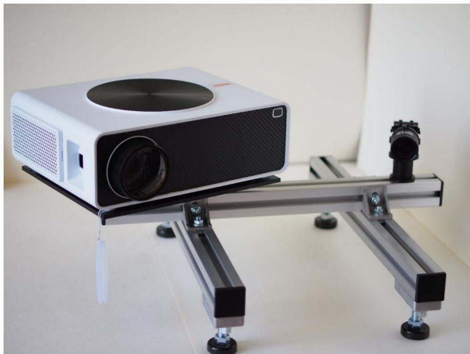
Рис. 3.14. Адаптивная триангуляционная система для прецизионного контроля параметров массообмена на аэродинамическом стенде ИТ СО РАН.
