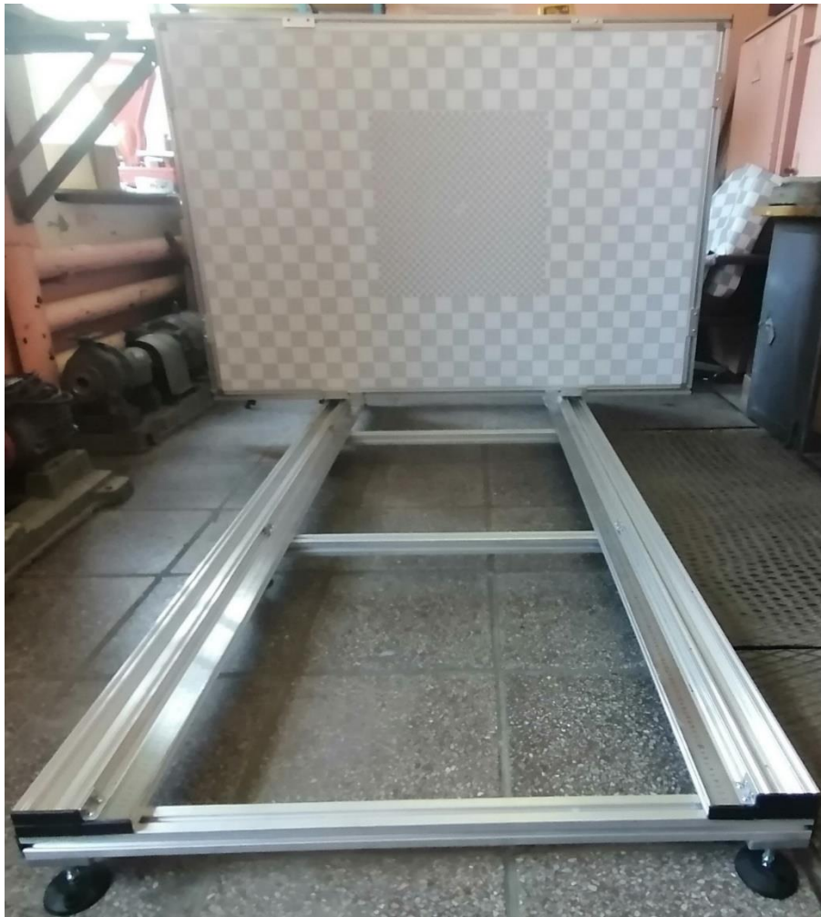
Рис. 3.21. Узел калибровки адаптивных триангуляционных систем для контроля деформаций трехмерного профиля объектов в процессе статического нагружения на силовом стенде.
