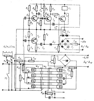
Обмотка реле защиты входит в состав кипп-реле (транзисторы  $T_3 - T_4$ ), обеспечивающего необходимую выдержку 12 сек (для получения выдержки 3 сек надо иметь  $C_5 = 50$  мк $\phi$ ) в соответствии с временем опроса одного датчика в цикле обегания. Запуск кипп-реле осуществляется входным ситналом через транзисторы  $T_1 - T_2$ , обеспечивающие равную чувствительность для положительного и отрицательного сигналов
