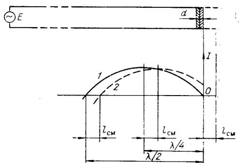
Следовательно, в реальной линии при внесении диэлектрика узлы напряжений и токов смещаются к концу линии на величину
