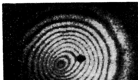
Рис. 6. Интерферограмма в реальном времени
