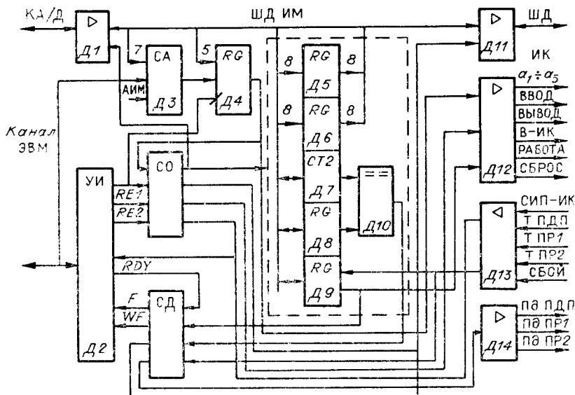
устройство, подключенное к ИК, по завершении цикла генерирует сигнал подтверждения СИП-ИК, который блоком синхронизатора обмена и БИС УИ передается в канал ЭВМ. На плате ИМ программно доступны регистры Д5 и Д6 (младший и старший байты слова), счетчик Д7, регистр Д8 и РССУ Д9. Управление доступом к ним осуществляется СО.
