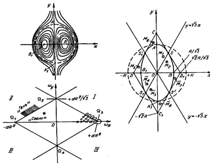
Рис. 5. Геометрооптическая интерпретация результатов дифракции
