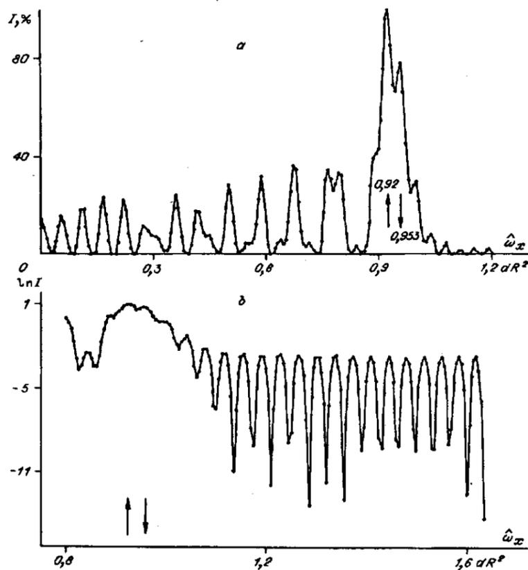
Рис. 6. Рассчитанное на ЭВМ распределение интенсивности волнового поля вдоль главного сечения дифракционной структуры (при  $\hat{\omega}_y = 0$ ):
