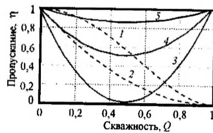
Рис. 3. Зависимости коэффициента пропускания дифракционных фильтров на основе амплитудных (кривые 1, 2) и фазовых (кривые 3–5) решеток от скважности решеток
