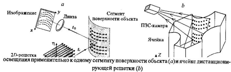
киноформных элементов, например с помощью двух скрещенных решеток Дамманна [8]. Распределение интенсивности света  $J(\xi, \eta)$  в точечном структурированном освещении представляет собой совокупность гауссовых пучков одинаковой интенсивности:
