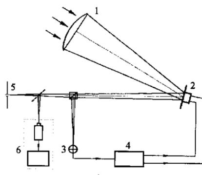
Рис. 2. Схема первого варианта макета адаптивной оптической системы: 1 – объектив телескопа; 2 – управляемое зеркало; 3 – приемное устройство; 4 – устройство управления; 5 – входная щель спектрографа; 6 – устройство для оптического контроля качества стабилизации изображения
