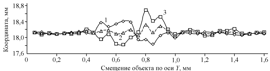
Рис. 3. Сравнение результатов измерений расстояния при помощи: первого канала измерителя (кривая 1), бинокулярной схемы измерителя (кривая 2), второго канала измерителя (кривая 3)
