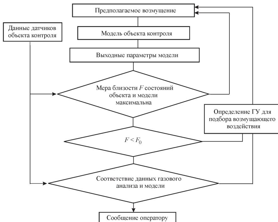
Рис. 4. Блок-схема итерационного алгоритма подбора вероятных возмущающих воздействий
