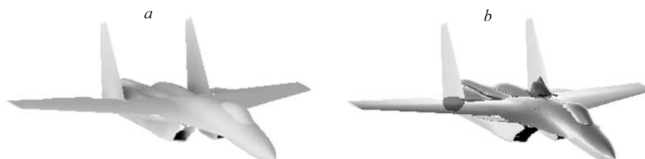
Рис. 1. Синтезированные изображения ЛА с различными индикатрисами диффузно-зеркального отражения: с преобладанием диффузной (а) и зеркальной (b) компонент отражения
