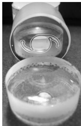
Рис. 5. Рефракционная (вверху) и дифракционная (внизу) матрицы для тиражирования линзы МИОЛ-Аккорд
